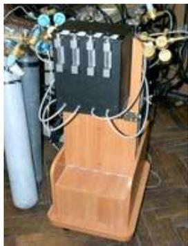
Предназначен для проведения работ по корректировке и поверке переносных и стационарных измерителей концентрации газов методом подачи поверочных газовых смесей.
